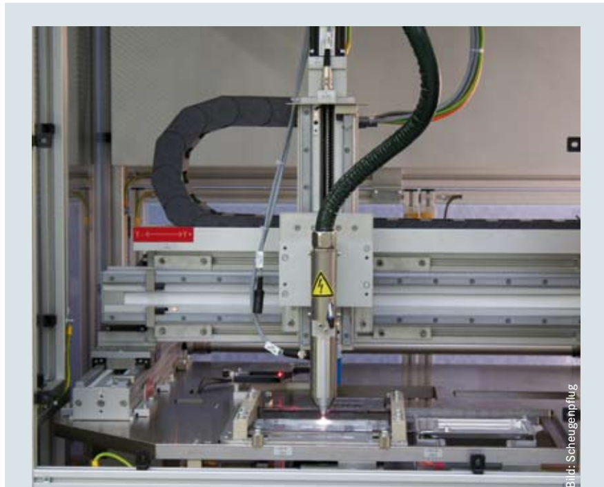
▲ Bild 4: Blick auf das Achssystem einer Plasmavorbehandlung
