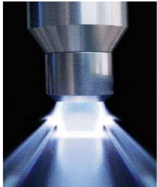
Mediante descarga de alta tensión, dentro de la tobera de plasma se genera plasma atmosférico
