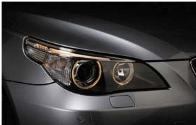
Las pantallas difusoras en los faros de automóviles se tratan previamente también con plasma atmosférico
