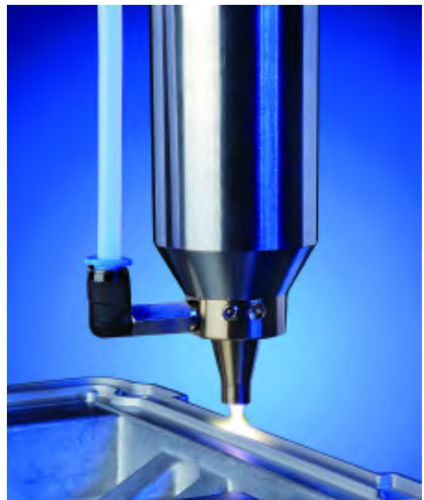
Imagen 1 Foto: Plasmatrete Hasta hace poco era posible sólo en cámaras de vacío: La tecnología de plasma atmosférico PlasmaPlus aplica recubrimientos en componentes de aluminio bajo presión atmosférica en la producción en serie.
